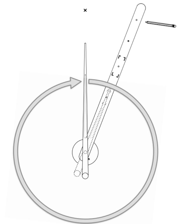
Para marcar el siguiente punto, gire manualmente 360º la minutera, y la horaria se situará automáticamente en la posición del siguiente punto.
